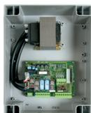
Centrale di comando 230 Vac con ricevitore 433,92 Mhz incorporato
