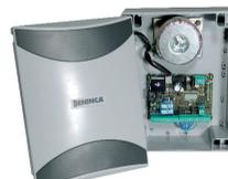
Centrale 24 V per cancelli ad ante battenti, ricevitore integrato 433,92 Mhz, programmazione logiche funzionamento tramite display.
