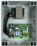
Centrale di comando 230 Vac completo di ricevitore radio 433,92 Mhz
